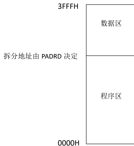
图 7-3-1 16K Flash 存储器结构
